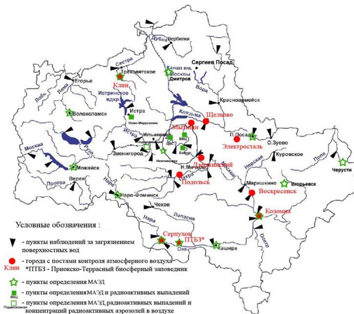
Рис. 4.1. Государственная наблюдательная сеть за загрязнением атмосферного воздуха, поверхностных вод и радиационным загрязнением на территории Московского региона (МАЭД - мощность AMBIENTного эквивалента дозы)
