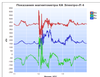
Рис. 1.4. Регистрация магнитного возмущения прибором ФМ-ВЭ КА «Электро-Л» №4
